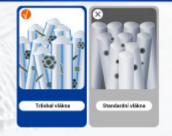
Tvar přičného řezu trojstratného zaobleného profilovaného syntetického vlákna zajistí, že se zachyti více nečistot oproti běžnému kulatému vlákna zdůvodu větší filtrační plochy
